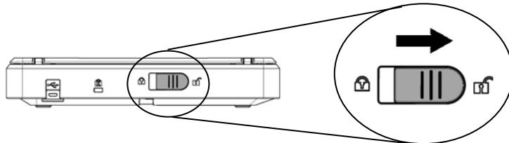
**Рисунок 1-1 Снятие блокировки сканера**
